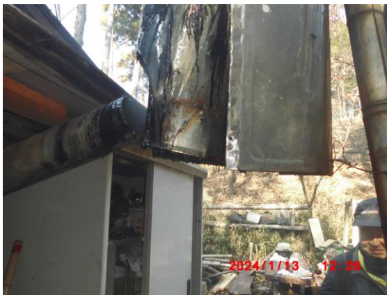
窯から出てくる排煙に含まれている木酢液を煙から抽出。
