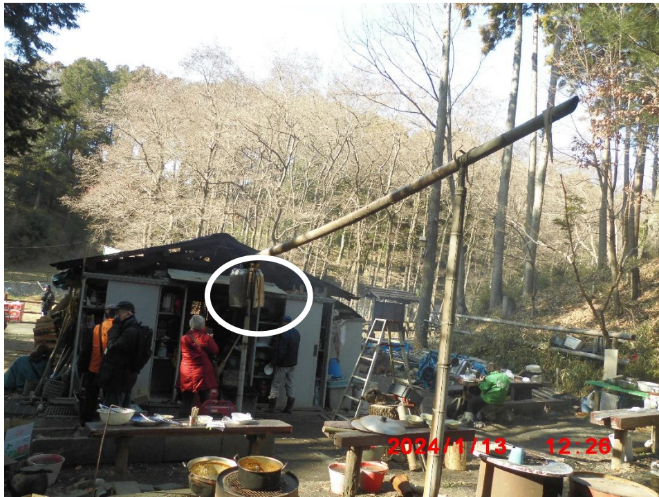
窯から出てくる排煙に含まれている木酢液を煙から抽出。
