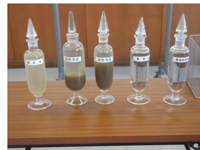
(写真12) 左から流入水、活性汚泥、活性汚泥、処理水、高度処理水
