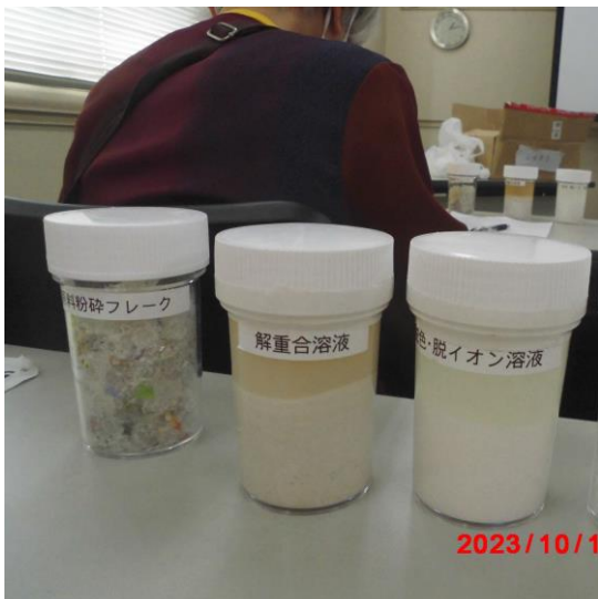
原料粉碎フレーク、脱色解重合溶液、脱イオン溶液、高純度 BHET,熔融重合ペレット、固相重合ペレット
