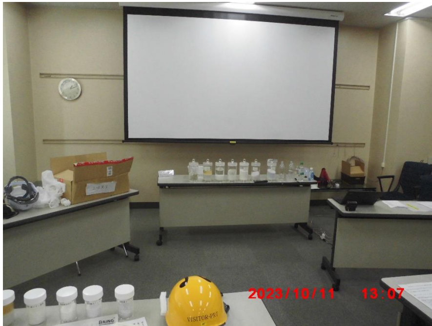
左の原料粉碎フレークから右の固相重合ペレットまで化学処理工程順に並べてある。
