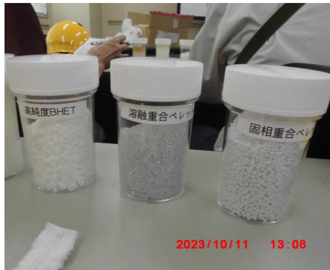
原料粉碎フレーク、脱色解重合溶液、脱イオン溶液、高純度 BHET,熔融重合ペレット、固相重合ペレット
