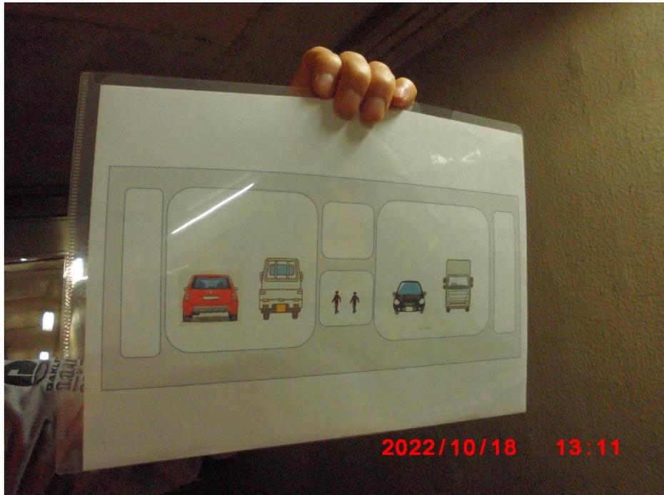
海底トンネルの断面図。これも良くわかりますね。車道の真ん中に歩道があります。車両の事故・火災などに緊急に退避する歩道としての役割もあります。
