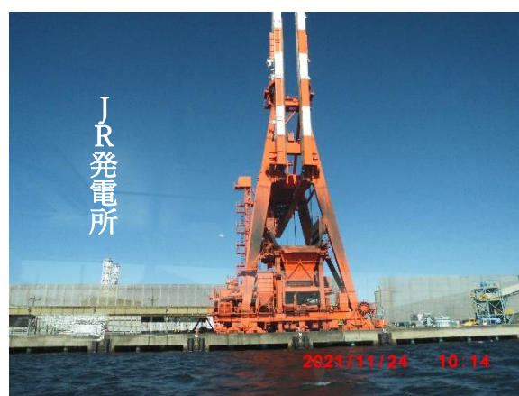
三井埠頭。アンローダー（船から荷揚げする機械）と背後の煙突はJR発電所。
