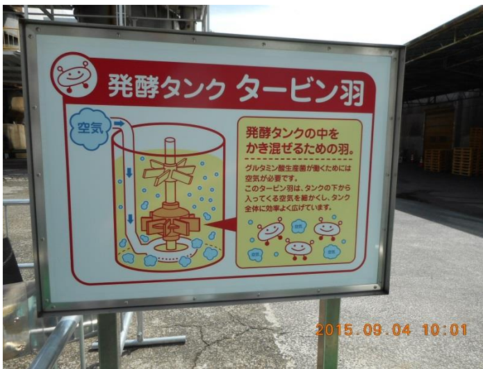
発酵タンクの内部の構造の仕組みを説明するパネル。
