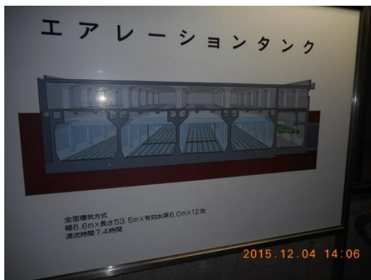
エアレーションタンク。空気を送り込んで微生物の働きで有機物を分解して汚物を沈殿させる。
