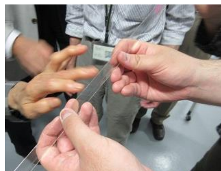
写真3 面取したガラスのエッジ
