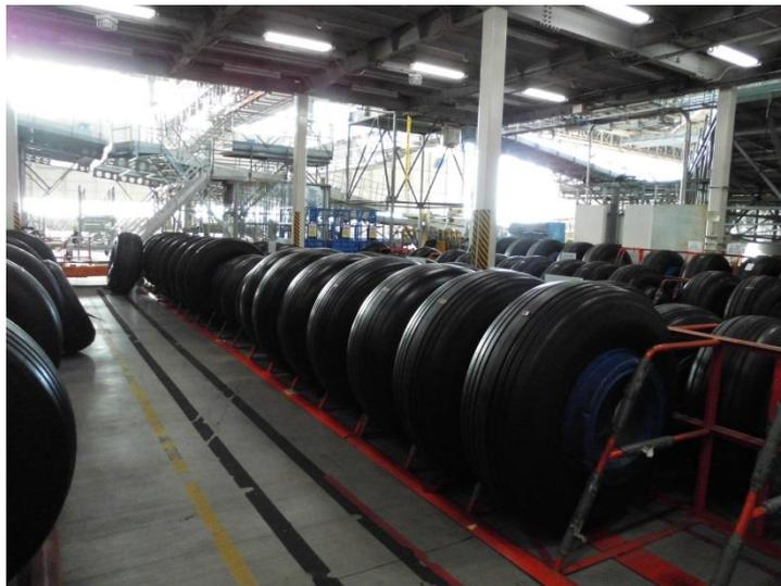
飛行機のタイヤ。ブリジストン、横浜ゴム、東洋タイヤ、ミュッシュランなどいろんなメーカーのタイヤを危機管理のため使っているとのことでした。このタイヤは走行方向に溝が彫られていてその溝の深さで交換時期を判断するとのこと。
